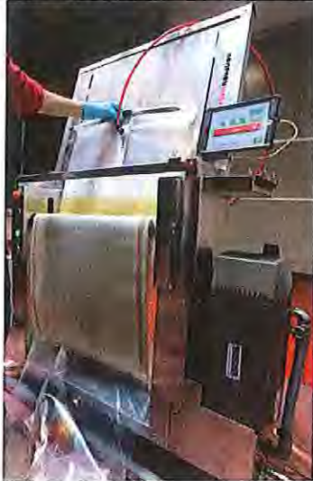
1. Tränken Sie die Glasfasermatte auf dem Vakuum-Imprägnierer mit PARTLINER™-Harz.
